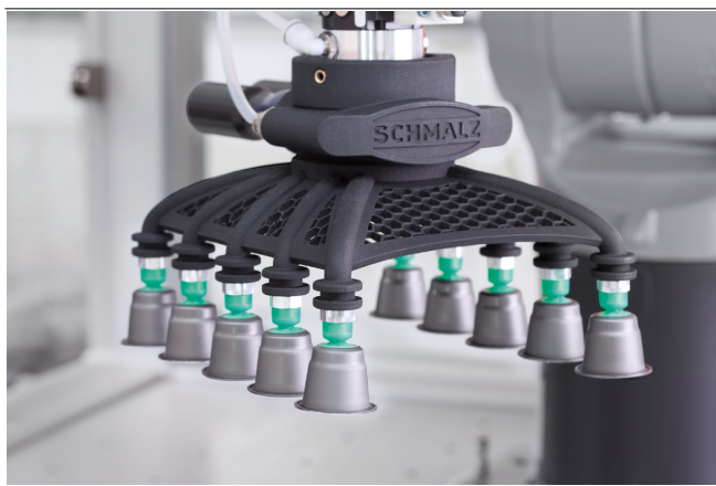
Ventosa SFF / SFB1 durante la manipolazione delle capsule di caffè
